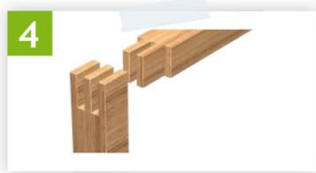
Assemblage par double enfourchement
